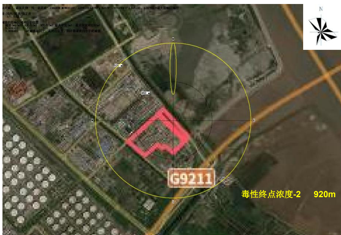
图 7.3-1 碳五储罐泄漏发生火灾，次生 CO 达到不同毒性终点浓度的最大影响范围（最不利气象）
