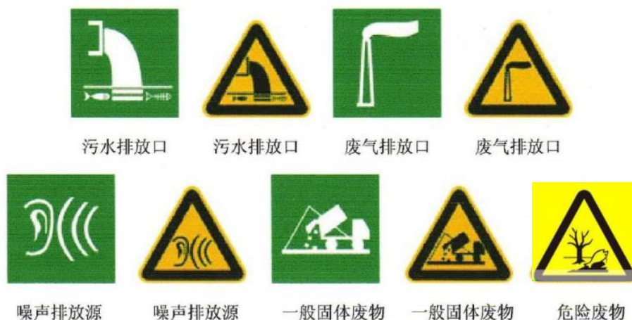
图 12.3-1 排放口图形标志图(背景绿色表示提示图形,背景黄色表示警告图形)
