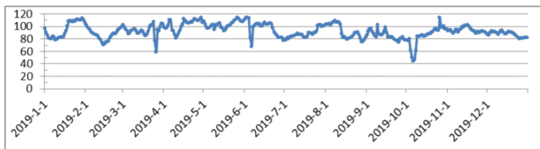
图 2.6-1 清环保工业污水厂 2019 年出水口 COD 排放数据曲线图
